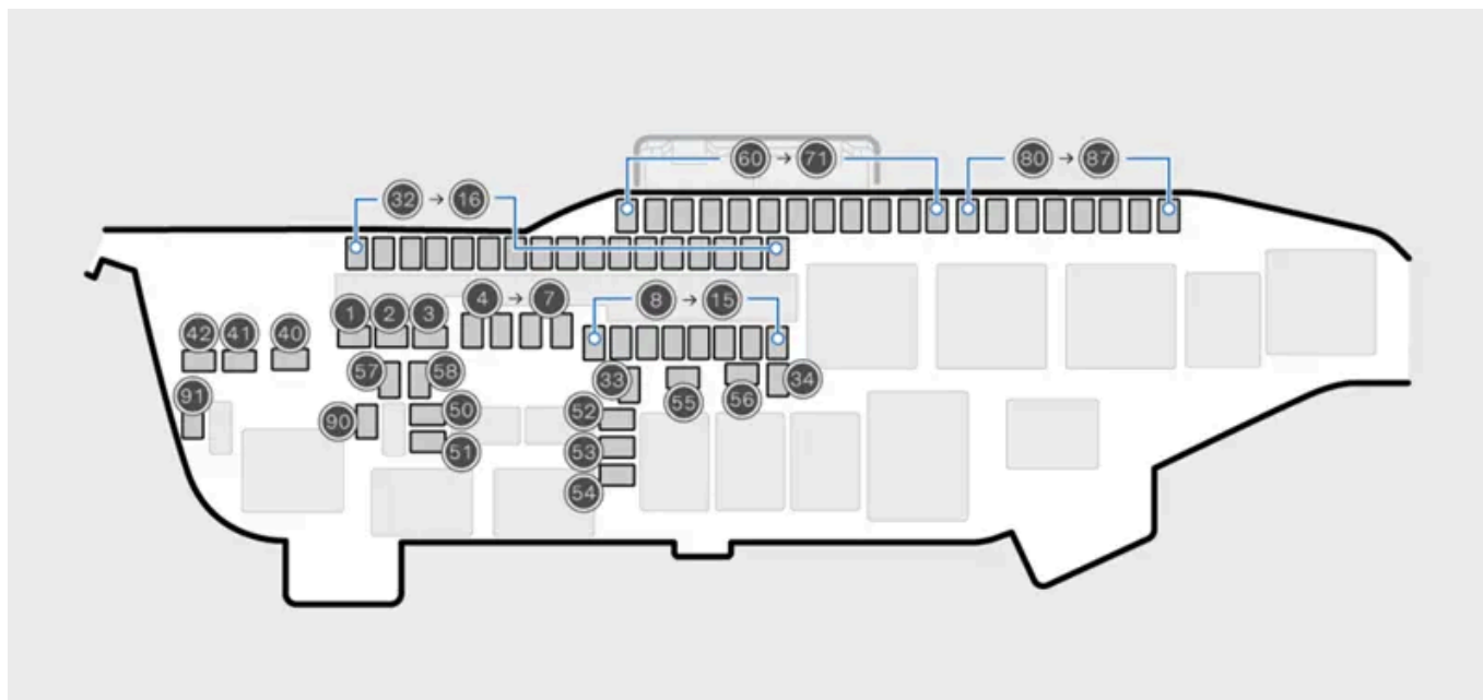
Diagramme montrant la position des fusibles
