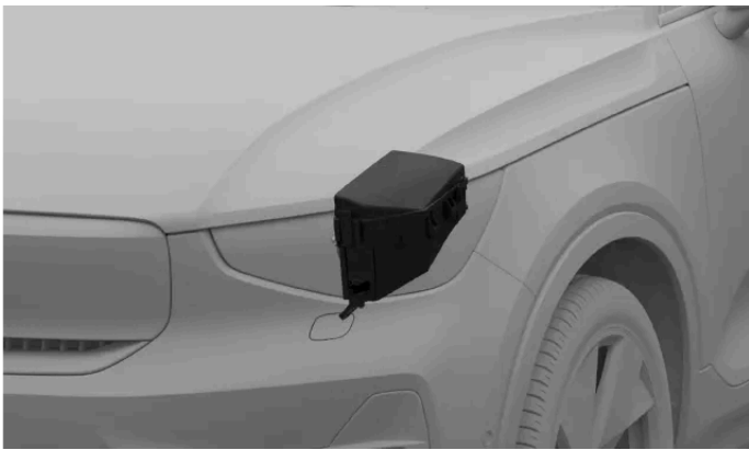
Emplacement de la boîte à fusibles
