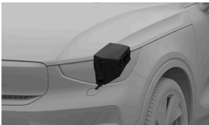
Emplacement de la boîte à fusibles
