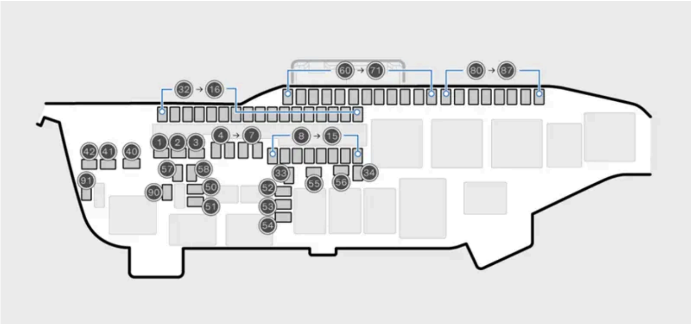
Diagramme montrant la position des fusibles
