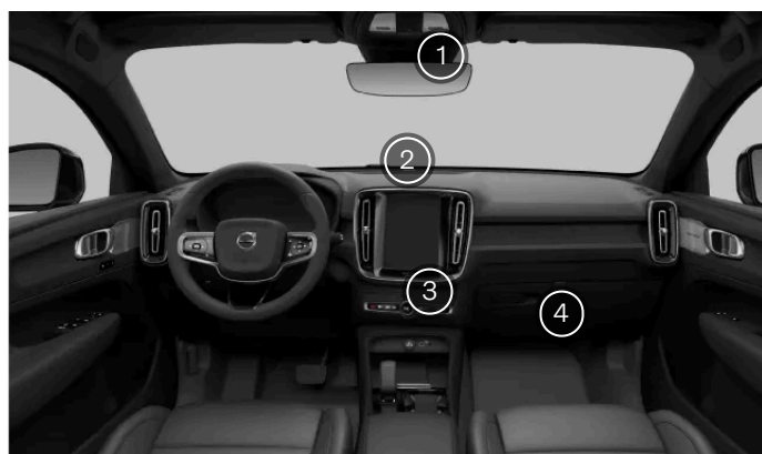
Capteurs intérieurs de climatisation
