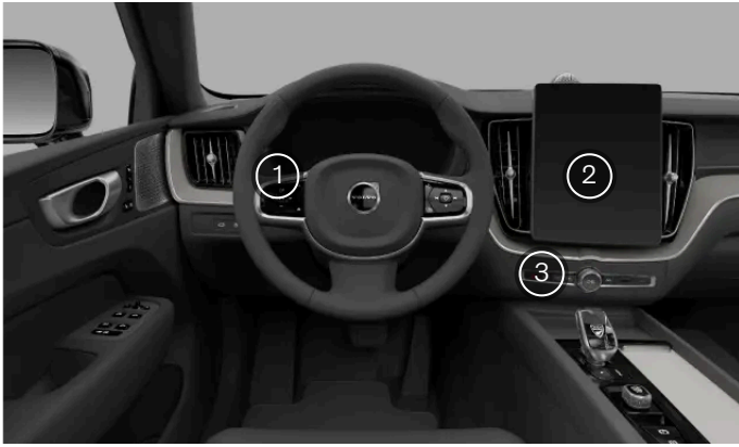
Position des commandes des feux extérieurs
