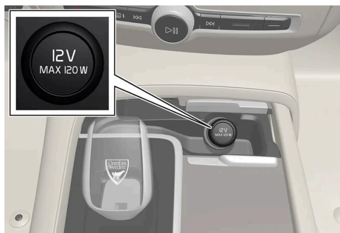
Prise électrique avant de console de tunnel pour voitures avec chargeur de téléphone par induction*.
