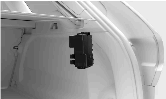
Emplacement de la boîte à fusibles
