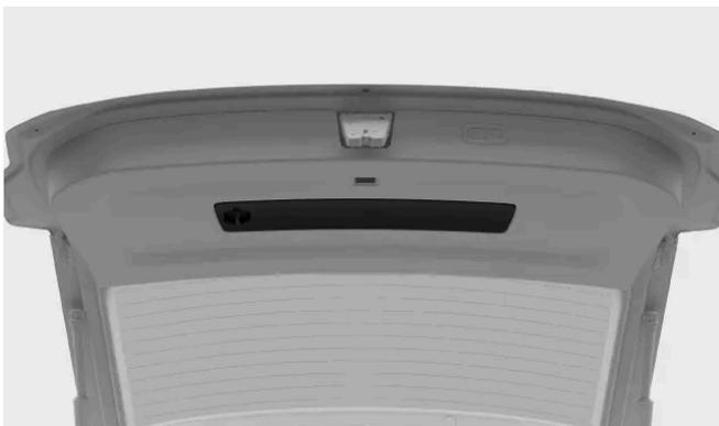
Le triangle de présignalisation est rangé à l'intérieur du hayon/couvercle de coffre. Ouvrez le compartiment en tournant la manette à la verticale, puis en la tirant.
