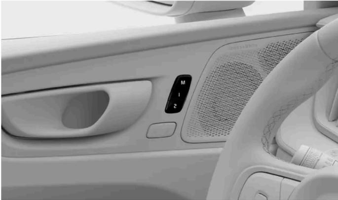
Emplacement des boutons de pré réglages de siège
