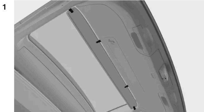
Guidez l'une des broches du couvercle du hayon/couvercle de coffre dans le support situé d'un côté du hayon/couvercle de coffre.
