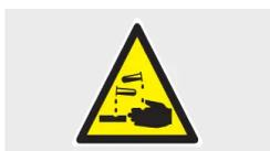
La batterie contient de l'acide corrosif.
