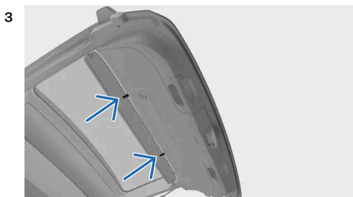
Poussez les deux clips situés sur le côté long du couvercle de hayon/couvercle de coffre vers le haut et enclenchez-les sur le hayon/couvercle de coffre.
