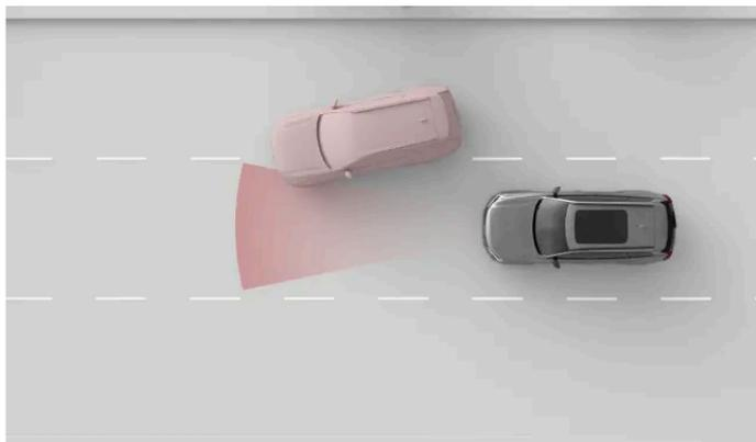
La largeur de la zone de détection du radar avant est limitée. Si un autre véhicule vous fait une queue-de-poison, la détection peut se produire assez tardivement et entraîner une réponse soudaine de votre voiture.
