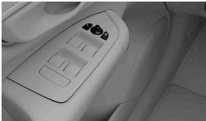
Commandes de réglage des rétroviseurs extérieurs
