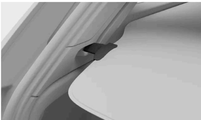
Soulevez et tirez l'extrémité de la protection du cache-bagages par la poignée pour la déverrouiller. Cela permet au couvercle de cache-bagages de se rétracter.
