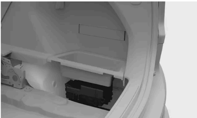
Emplacement de la boîte à fusibles
