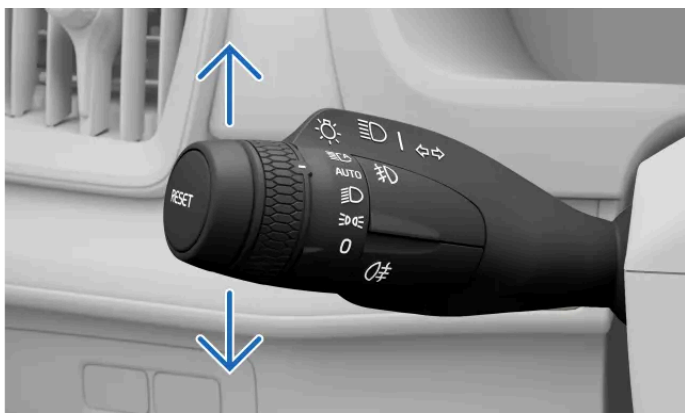
Clignotants sur le levier au volant gauche
