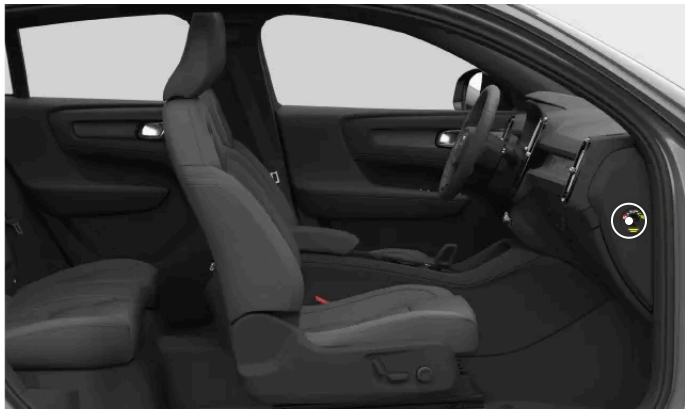
Locatie van de schakelaar voor de passagiersairbag
