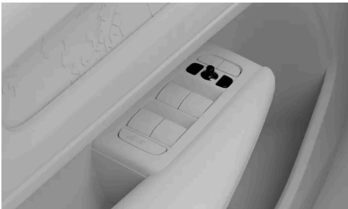
Knoppen voor het verstellen van de buitenspiegels
