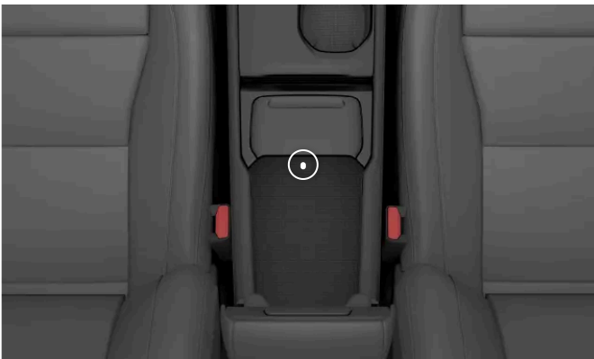
Locatie van de back-uplezer in het opbergvak van de tunnelconsole
