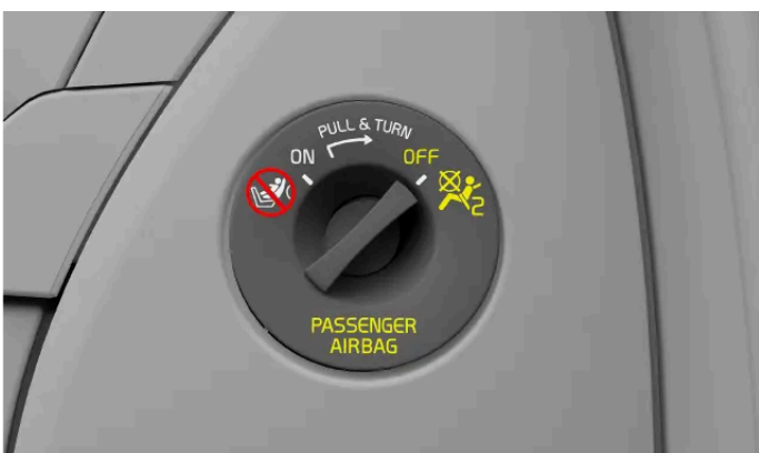
Airbags uitgeschakeld. Gebruik deze stand altijd wanneer een naar achteren gericht kinderzitje op de voorpassagiersstoel is geplaatst.
