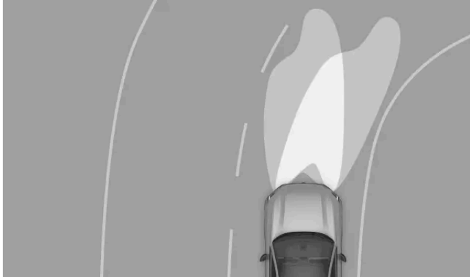
Typische werking van de actieve bochtverlichting
