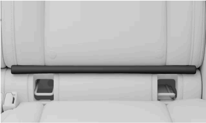
De opgevouwen ISOFIX-flap, weggestopt in de opening boven de verankeringspunten
