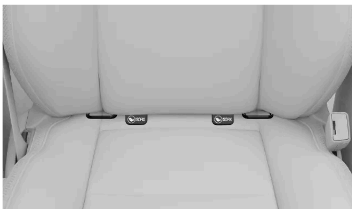
Locatie van ISOFIX-verankeringspunten voor de voorpassagiersstoel
