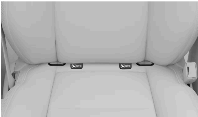
Locatie van ISOFIX-verankeringspunten voor de voorpassagiersstoel
