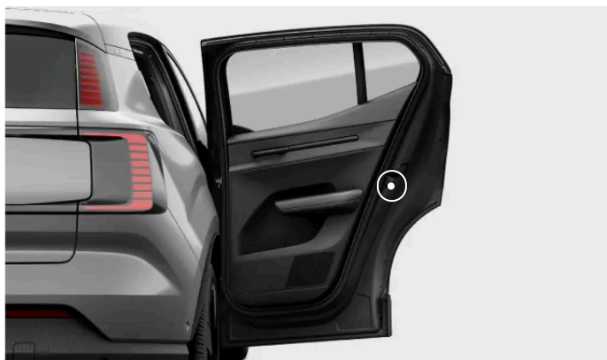
Positie van de schakelaar van het kinderslot.
