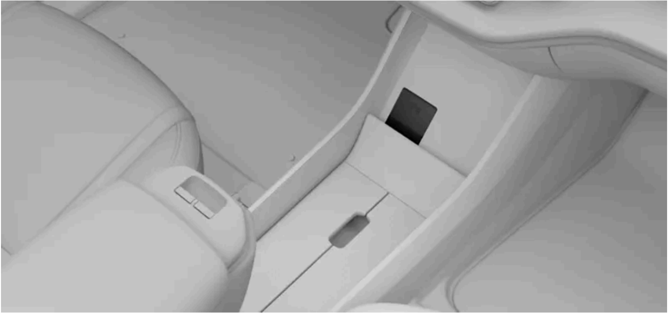
De draadloze lader onder het display
