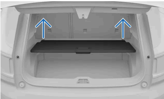
Illustratieve gids voor het verwijderen van het luik in de bagageruimte.
