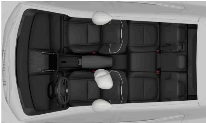
Airbags voor aanrijdingen van opzij voor de voorste inzittenden.
