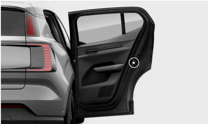
Positie van de schakelaar van het kinderslot.
