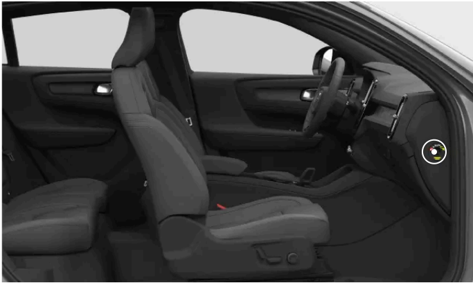
Locatie van de schakelaar voor de passagiersairbag
