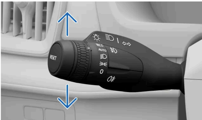
De richtingaanwijzers op de linkerhendel
