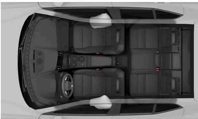
Zijairbags voor de inzittenden voorin.
