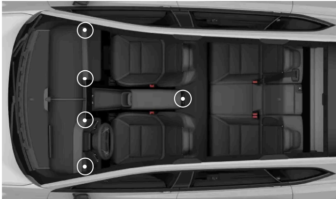
De posities van de verstelbare blaasmonden in het interieur.
