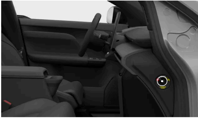
Locatie van de schakelaar voor de passagiersairbag
