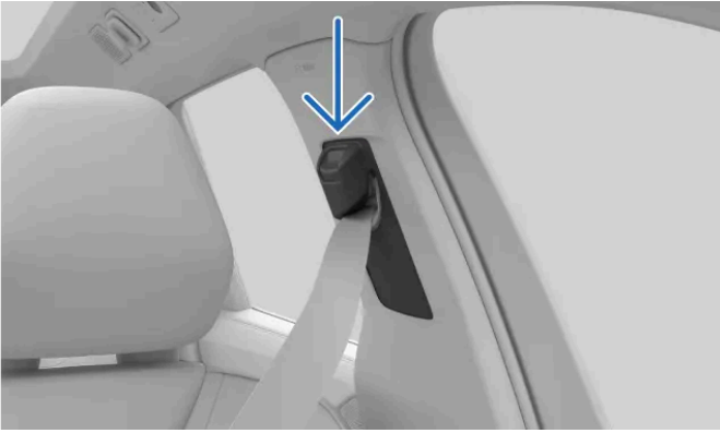
Bovenste bevestigingspunt van de stoel
