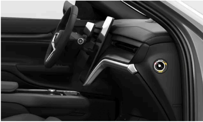
Locatie van de schakelaar voor de passagiersairbag
