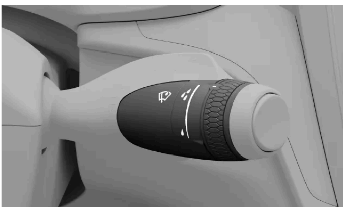
De bedieningselementen voor de ruitenwissers voor de voorruit bevinden zich op de rechterstuurhendel.
