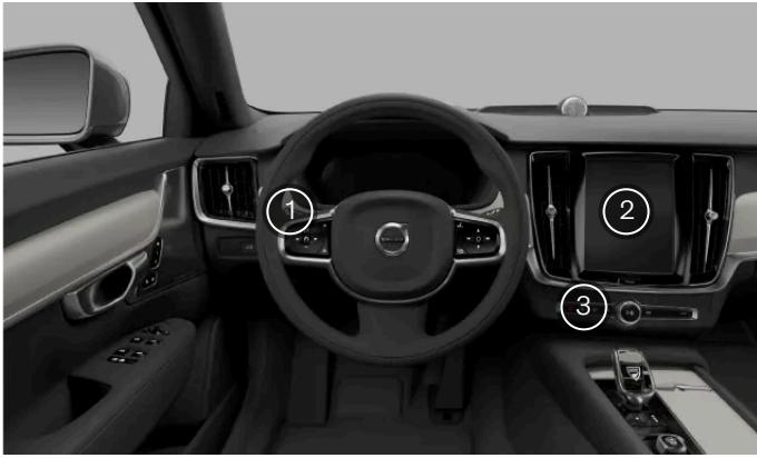
Locaties van bedieningselementen voor de buitenverlichting
