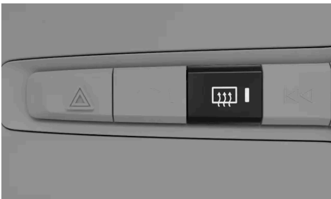
Knop van achterrautontdooier op het bedieningspaneel onder het middendisplay
