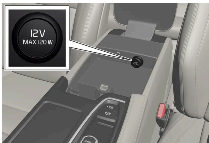
12V-aansluiting in tunnelconsole, voorin.
