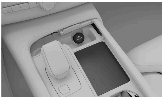
De 12V-aansluiting in de tunnelconsole
