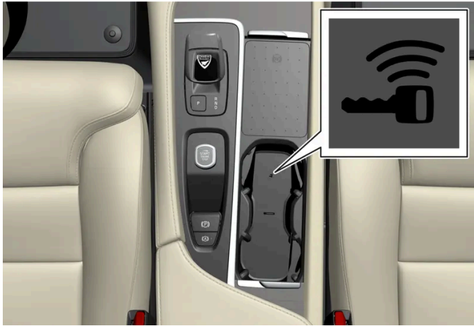
Positie back-uplezer in de tunnelconsole.
