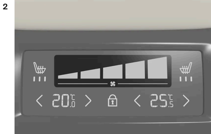
Ventilatorregeling op klimaatpaneel achter op tunnelconsole.
