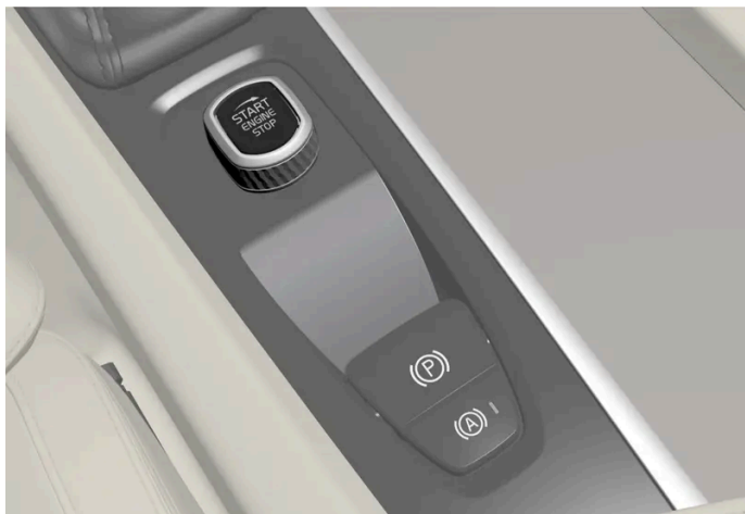
De startknop op de tunnelconsole.
