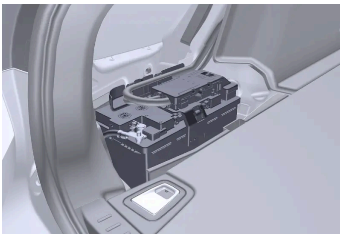
De startaccu zit in de bagageruimte.
