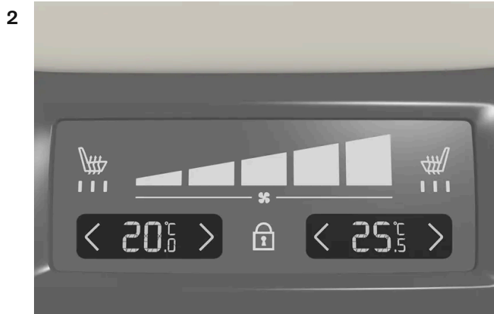
Temperatuurregeling op klimaatpaneel achter op tunnelconsole.
