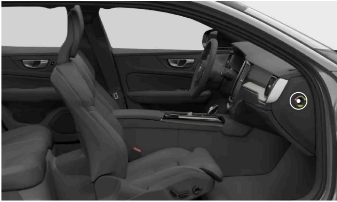
Locatie van de schakelaar voor de passagiersairbag
