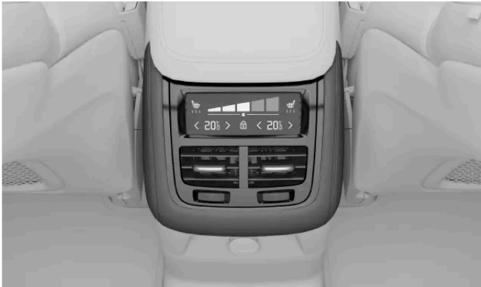
Bedieningselementen voor het klimaatsysteem op de tunnelconsole
