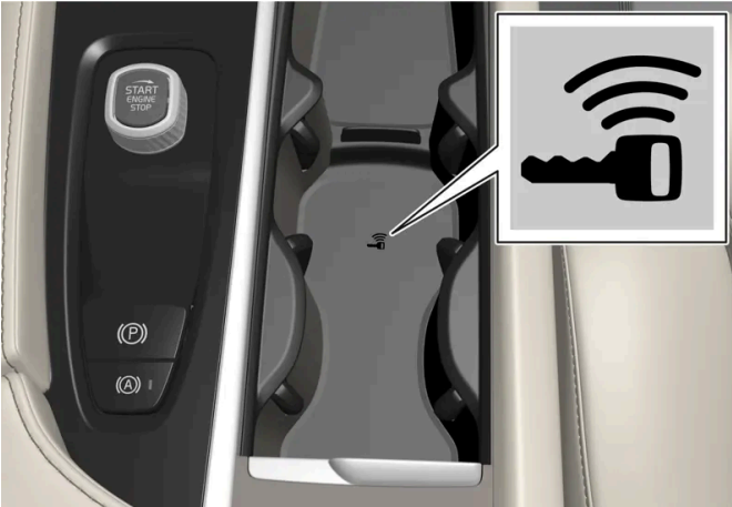
Positie back-uplezer in de tunnelconsole.
