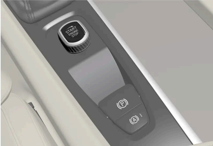
De startknop op de tunnelconsole.
