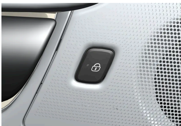
Vergrendelingsknop met controlelampje in achterportier.
