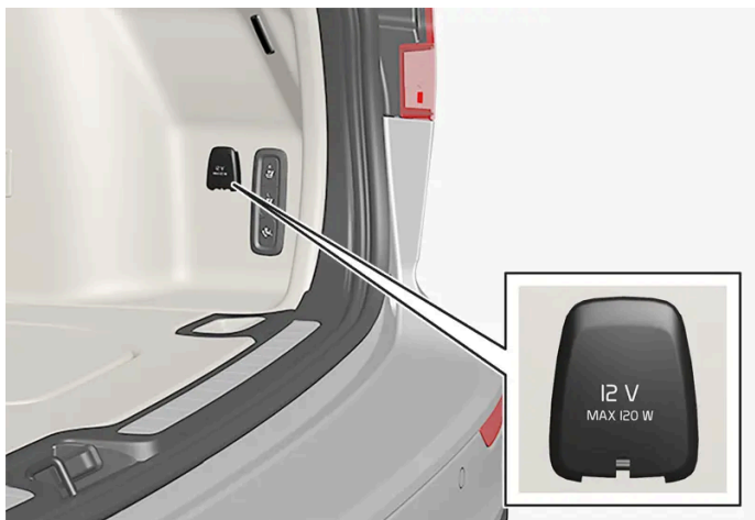
12V-aansluiting in kofferbak/bagageruimte*.
