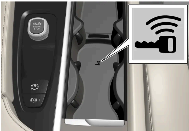
Positie back-uplezer in de tunnelconsole.
