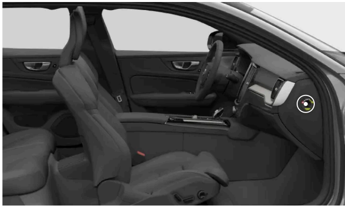
Locatie van de schakelaar voor de passagiersairbag
