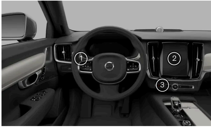
Locaties van bedieningselementen voor de buitenverlichting
