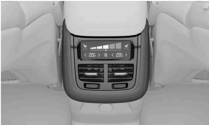
Bedieningselementen voor het klimaatsysteem op de tunnelconsole
