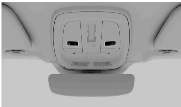
De leeslampjes voorin in de plafondconsole
