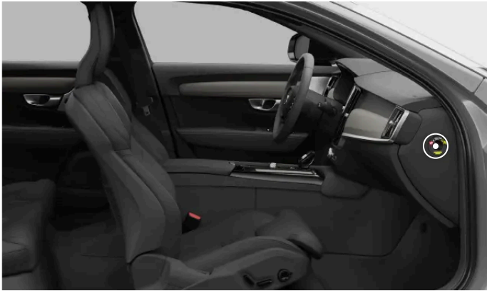
Locatie van de schakelaar voor de passagiersairbag
