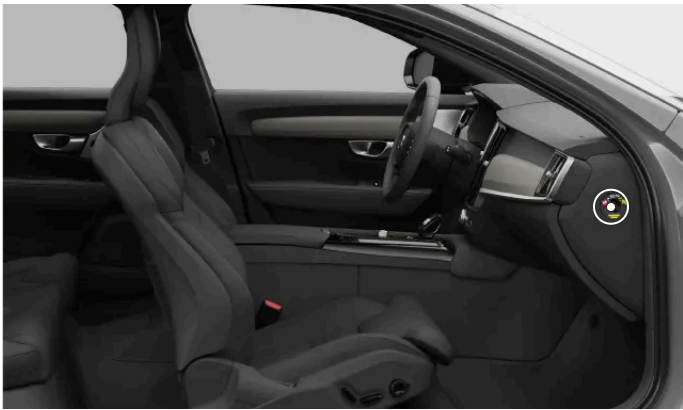
Locatie van de schakelaar voor de passagiersairbag
