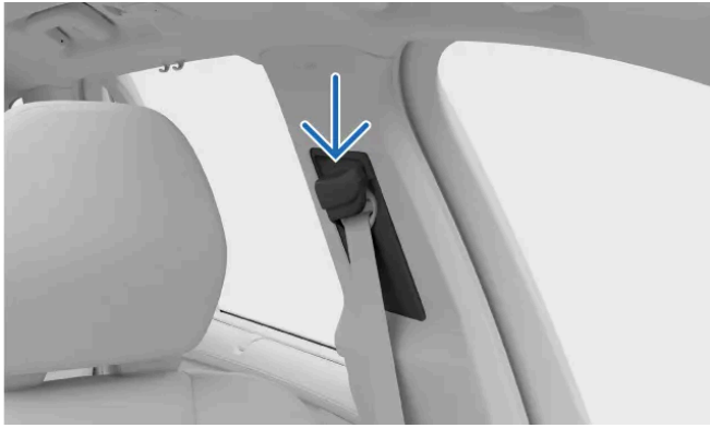
Bovenste bevestigingspunt van de stoel
