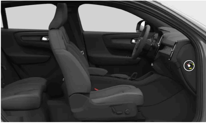
Locatie van de schakelaar voor de passagiersairbag
