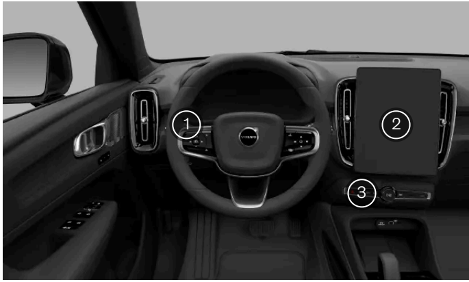
Locaties van bedieningselementen voor de buitenverlichting
