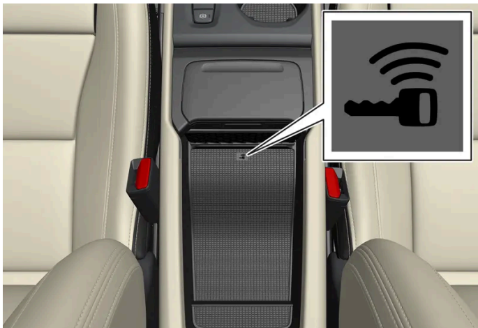
Positie back-uplezer in de tunnelconsole.
