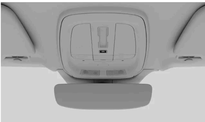
De knop voor het uitschakelen van de automatische verlichting in de plafondconsole
