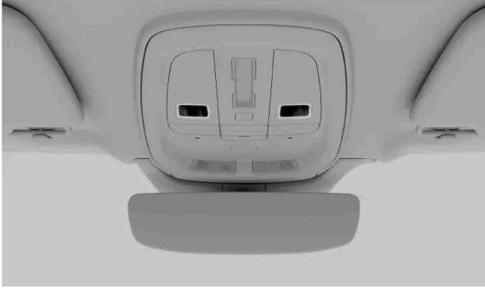
De leeslampjes voorin in de plafondconsole
