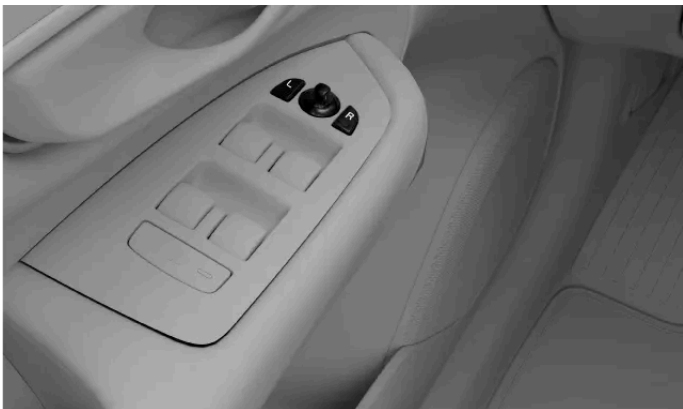
Knoppen voor het verstellen van de buitenspiegels
