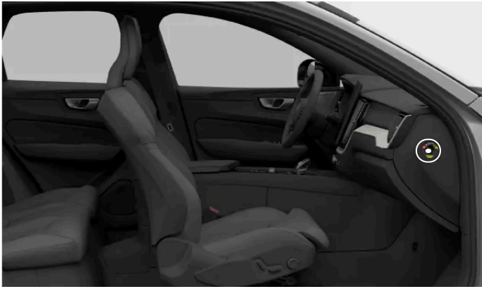
Locatie van de schakelaar voor de passagiersairbag
