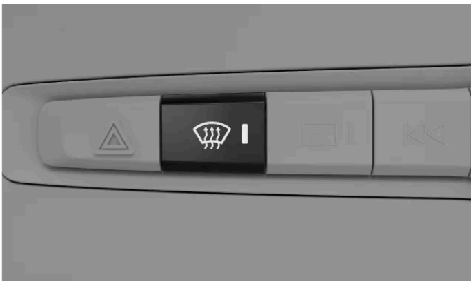
Knop voor maximale ontdooifunctie op het bedieningspaneel onder het middendispley
