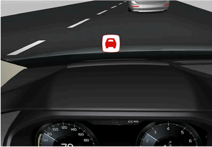
Symbol voor Collision Warning onder aan de voorruit
