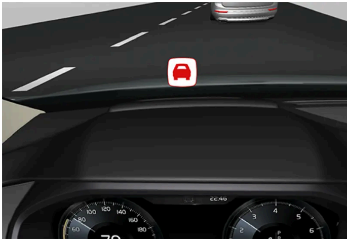
Symbool voor Collision Warning onder aan de voorruit
