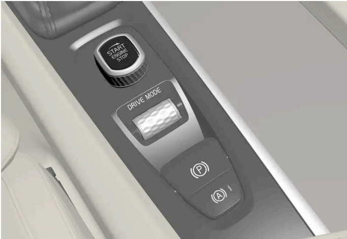
De startknop op de tunnelconsole.
