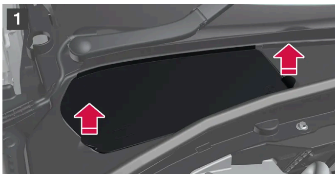
Expansiereservoir voor koelsysteem, auto met het stuur rechts
