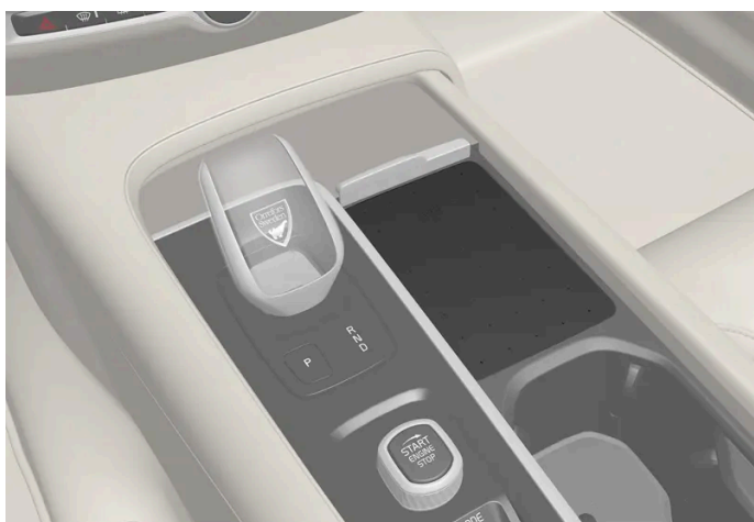
Draadloze telefoonoplader in de tunnelconsole.
