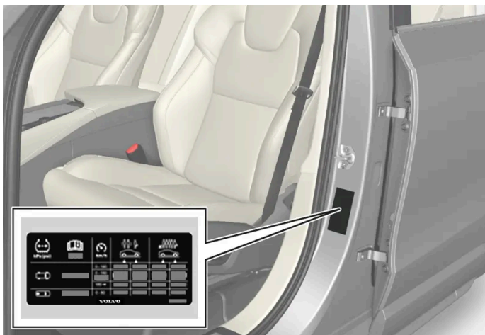
Positie van de bandenspanningsstickers
