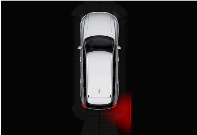
Brandend pictogram voor Cross Traffic Alert in de grafische Parkeerhulpsysteem -voorstelling op het display.
