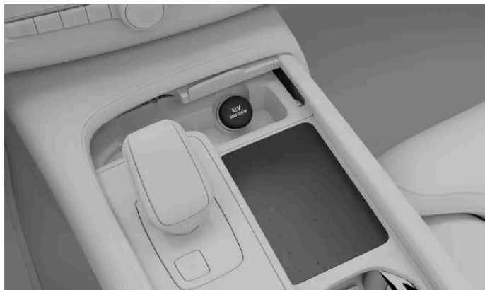
De 12V-aansluiting in de tunnelconsole
