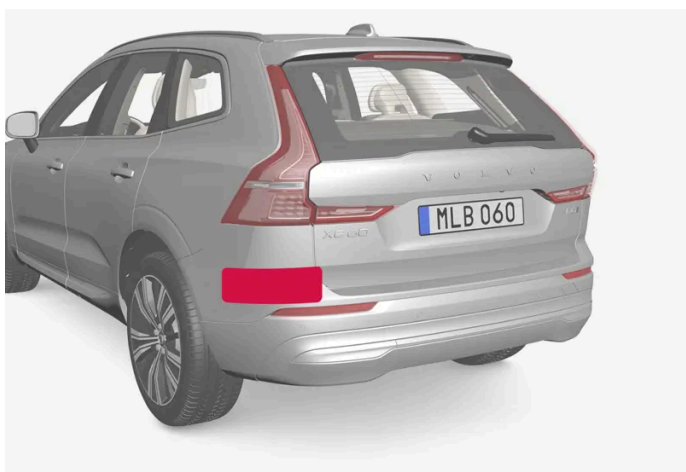
Locatie van de radarsensoren aan de achterzijde
