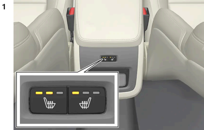
Knoppen voor elektrische achterbankverwarming achter op tunnelconsole.
