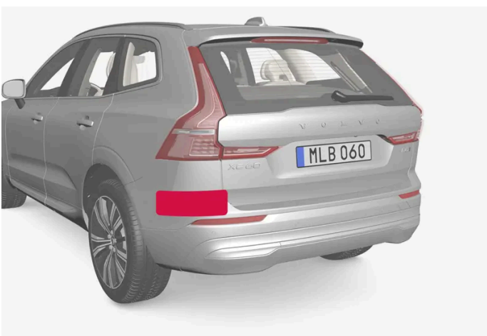
Locatie van de radarsensoren aan de achterzijde
