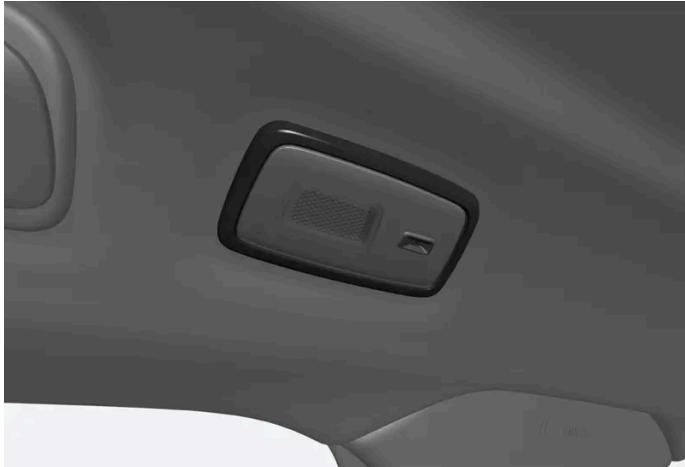
In een auto met panoramadak* zitten de twee lampeenheden aan beide kanten van het plafond.
